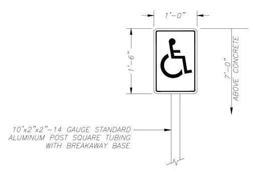
ALL NEW FLAT SHEET SIGN BLANKS SHALL BE ENGINEER GRADE OF ALUMINUM ALLOY AND 0.08" THICKNESS.
